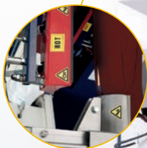
Dispositif pressage pour fentes de manche teflonné
